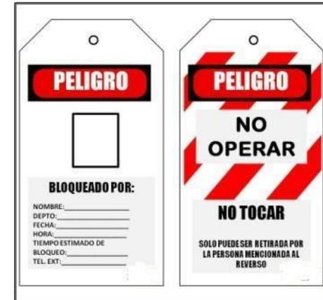
El mecanismo de etiquetado es una etiqueta y la forma de pegarla para que pueda resistir una fuerza de 50 libras. (Algunos dispositivos de etiquetado se pegan con un alambre.) El mecanismo de etiquetado se debe usar solamente cuando no se puede bloquear la electricidad. La etiqueta deberá tener un rótulo que diga que nadie puede encender el equipo ni quitar el dispositivo de aislamiento de la energía sin el debido permiso.
